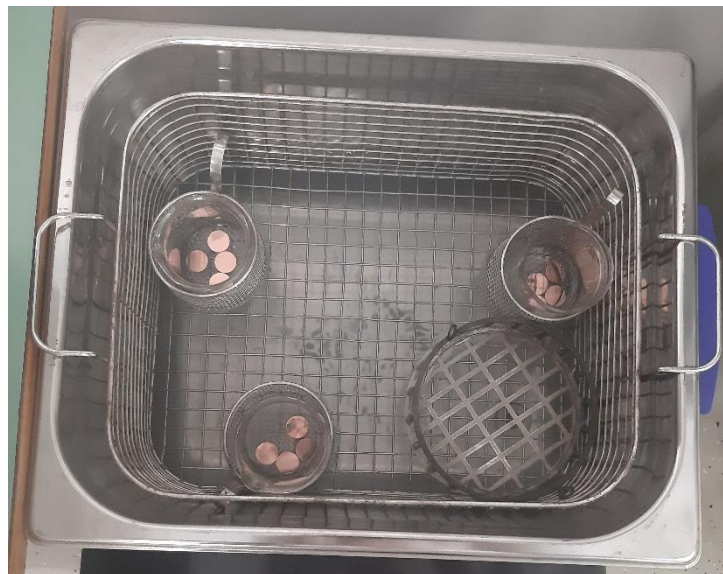
Slika 27. Ultrazvučna kupelj za odmašćivanje uzoraka bakra.
