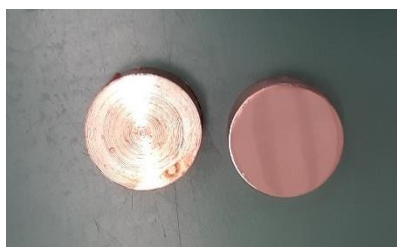
Slika 25. Usporedba sirovog (lijevo) i ispoliranog (desno) uzorka bakra.
