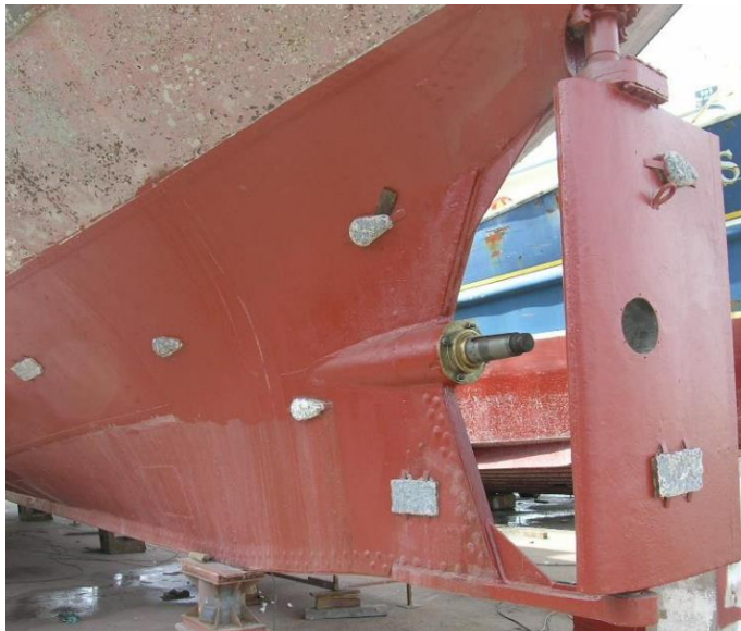
Slika 16. Zaštita čeličnog trupa broda primjenom žrtvovanih anoda od cinka. 22
