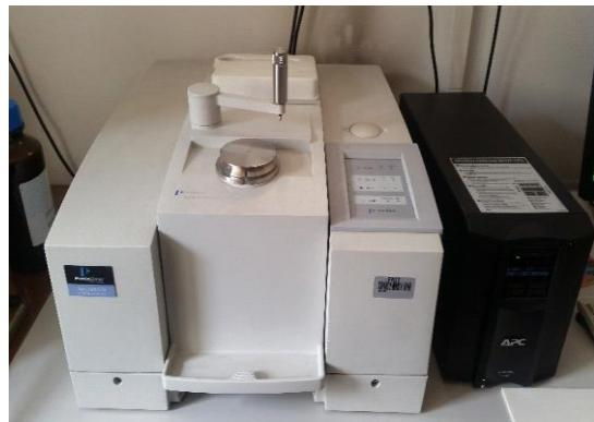
*Slika 29. FTIR-ATR spektrofotometar Spectrum One, Perkin Elmer*
