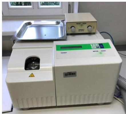
*Slika 28. DSC analizator 822<sup>e</sup>, Mettler Toledo*
