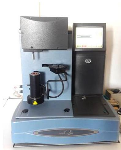
*Slika 30. Termogravimetar Q500 tvrtke TA Instruments*
