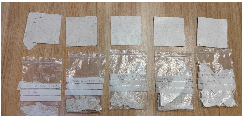
Slika 25. Biokompoziti LLDPE/RLJ/mTiO 2 s različitim udjelom RLJ
