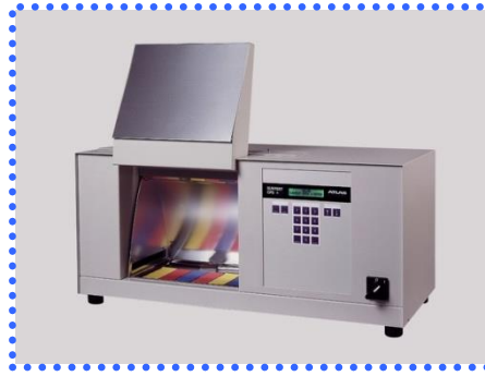
Slika 26. UV komora SUNTEST
