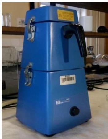
Slika 20. Mikser IKA-WERKE M20
