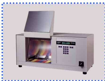
Slika 26. UV komora SUNTEST
