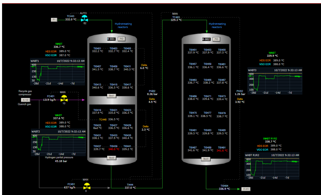
Slika 3.3. Grafički prikaz dijela reaktorske sekcije u sustavu za vođenje procesa
