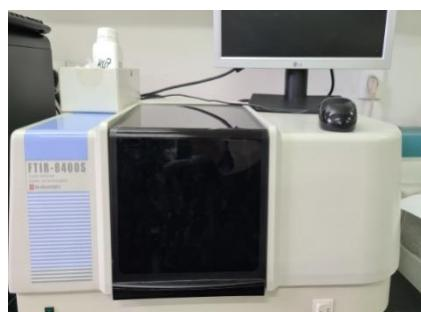
**Slika 3.3.** FTIR-ATR spektrometar.
