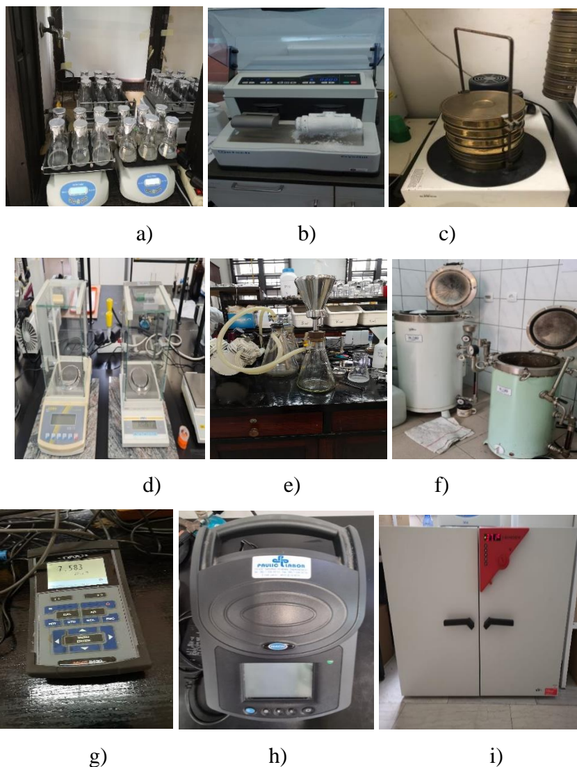
Slika 3.2. Mjerni instrumenti i oprema korišteni pri provođenju eksperimenta: a); rotacijska tresilica b); kriomlin c); mehanička sita d); analitička vaga e); vakumski filter lijevak f); autoklav g); prijenosni mjerač WTW h); spektrofotometar i); termostat.
