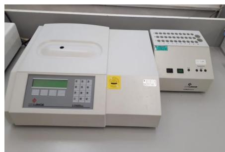
**Slika 3.4.** Korišteni luminometar i termostatni inkubacijski blok.
