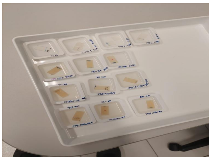
Slika 31. Ispitivani uzorci pripremljeni za test apsorpcije vode
