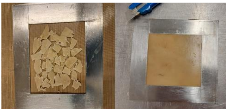
Slika 24. Materijal u kalupu; prije (lijevo) i nakon prešanja (desno)
