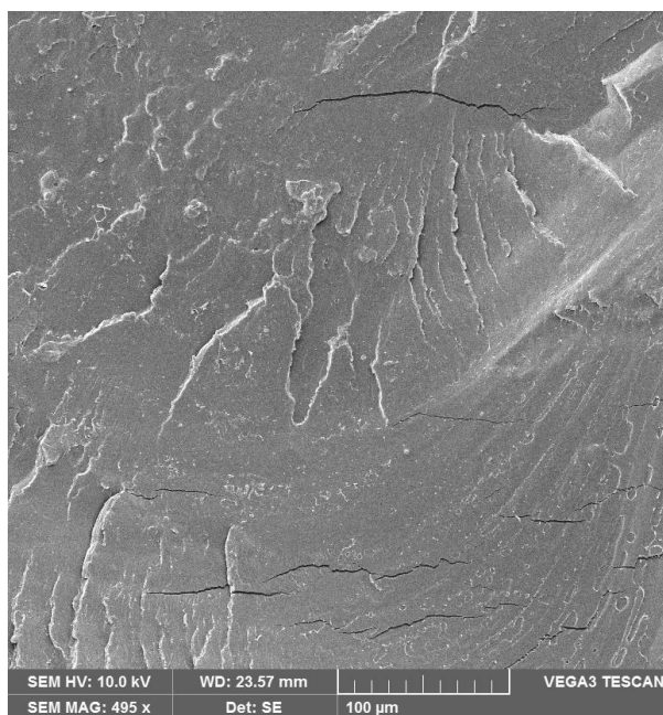
Slika 42. SEM mikrografija PLA
