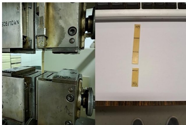
Slika 30. Statički vlačni test (lijevo) te epruveta nakon provedenog testa (desno)
