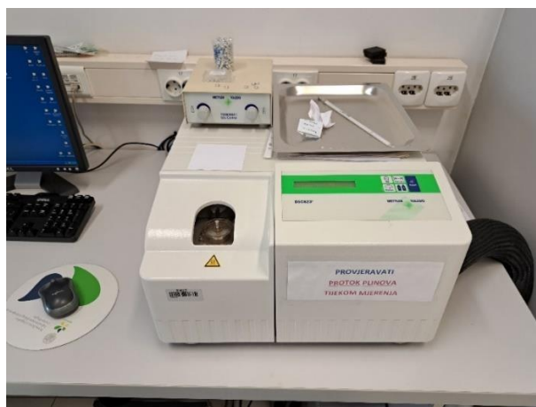
Slika 28. DSC instrument 823 e Mettler Toledo
