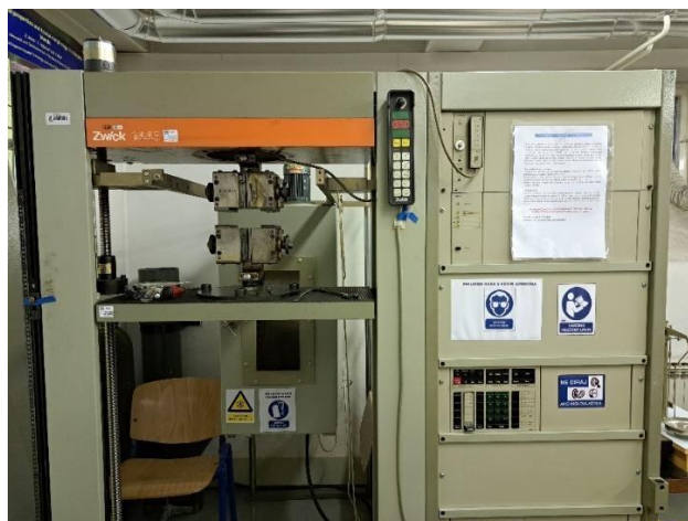
Slika 29. Univerzalna mehanička kidalica Zwick 1445
