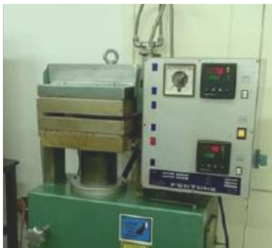
Slika 23. Hidraulička preša Fontuna
