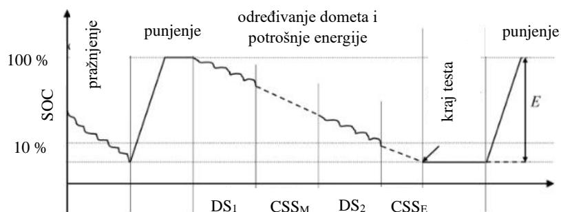
**Slika 19.** Određivanje dometa i potrošnje energije prema CLTC-u [46]
