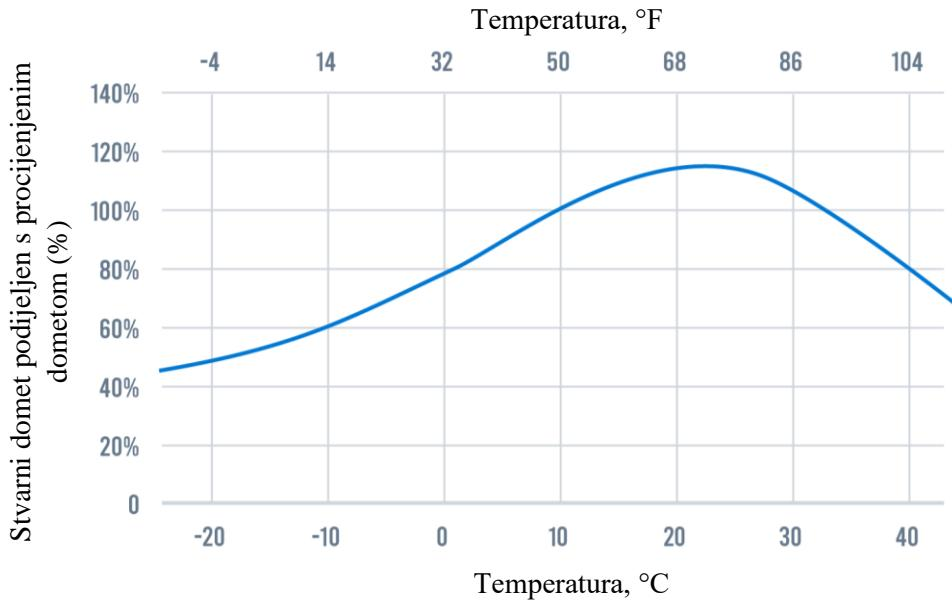
**Slika 9.** Utjecaj temperature na domet električnih vozila [25]
