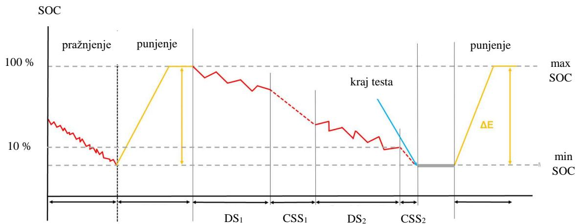
*Slika 13.* Određivanje dometa prema WLTP-u [35]
