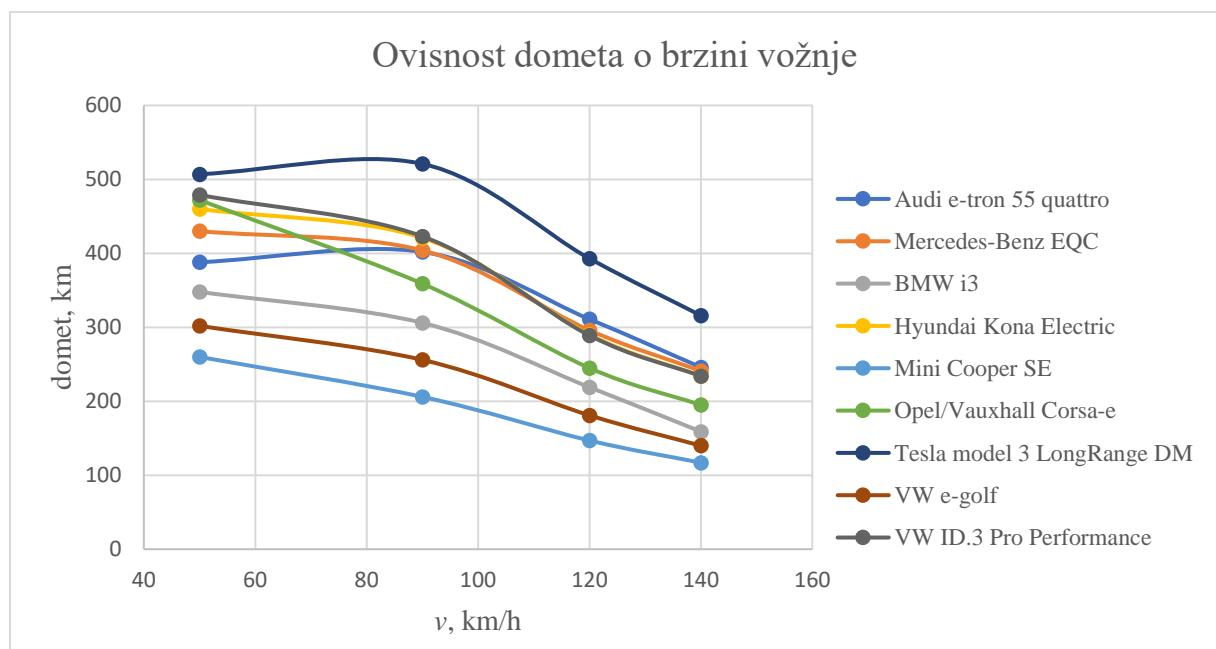
**Slika 30.** Grafički prikaz ovisnosti dometa o brzini vožnje za različita električna vozila
