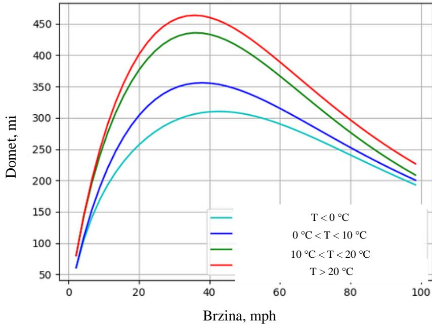
*Slika 7.* Utjecaj brzine na domet električnih vozila [18]
