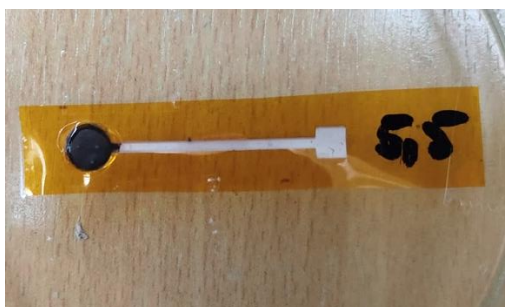
Slika 13. Inkjet ispisana elektroda s čvrstim kontaktom i amonij-selektivnom membranom.
