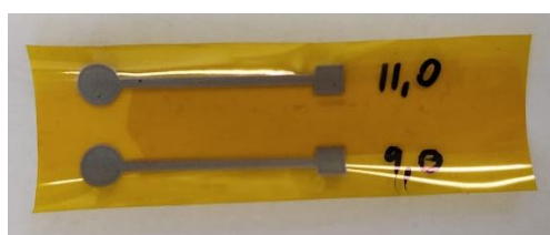
Slika 11. Inkjet ispisana srebrna elektroda, prije daljnje obrade.
