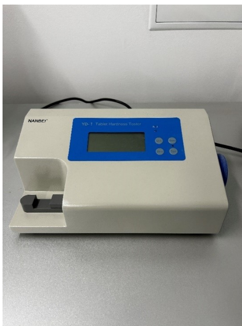
Slika 18. Uređaj za određivanje tvrdoće tableta YD – 1 Tablet Hardness Tester (Nanbei, Kina)
