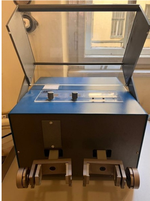
Slika 6. Vibracijski mlin In Solido Tech IST500
