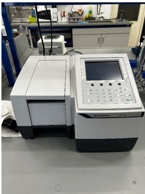
Slika 20. Spektrofotometar UV-1280 (Shimadzu, Kyoto, Japan)
