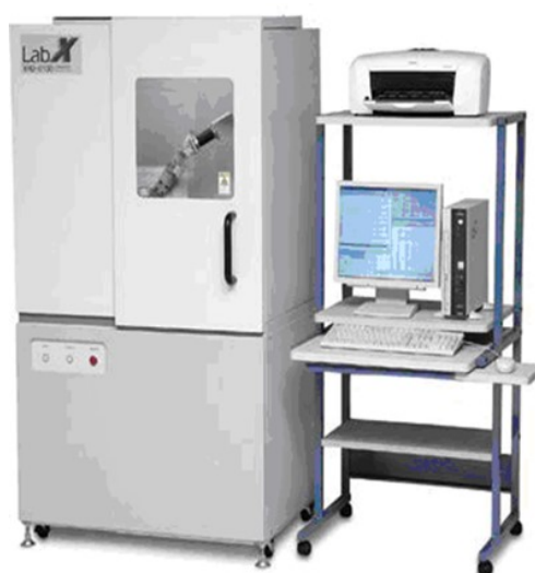
Slika 12. Uređaj za rendgensku difrakciju praha Shimadzu XRD – 6000
