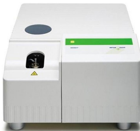
Slika 9. Diferencijalni pretražni kalorimetar Mettler Toledo 822e
