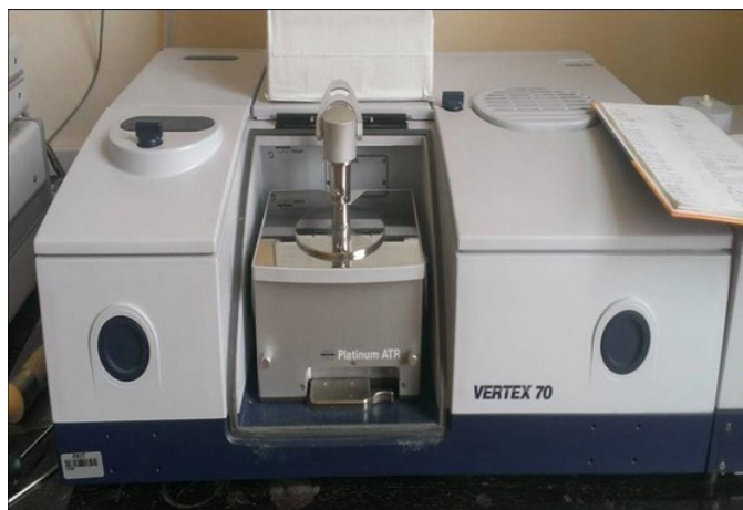
Slika 11. FTIR spektrofotometar Vertex 70 s platinastim detektorom
