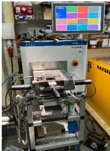
Slika 18. Brabender gnjetilica (FSB)
