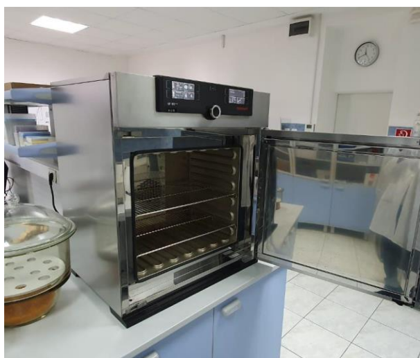
Slika 15. Memmert UF 110 peći za sušenje
