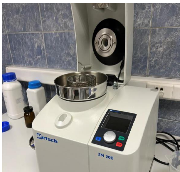
Slika 16. Retsch ZM 200 mlinu
