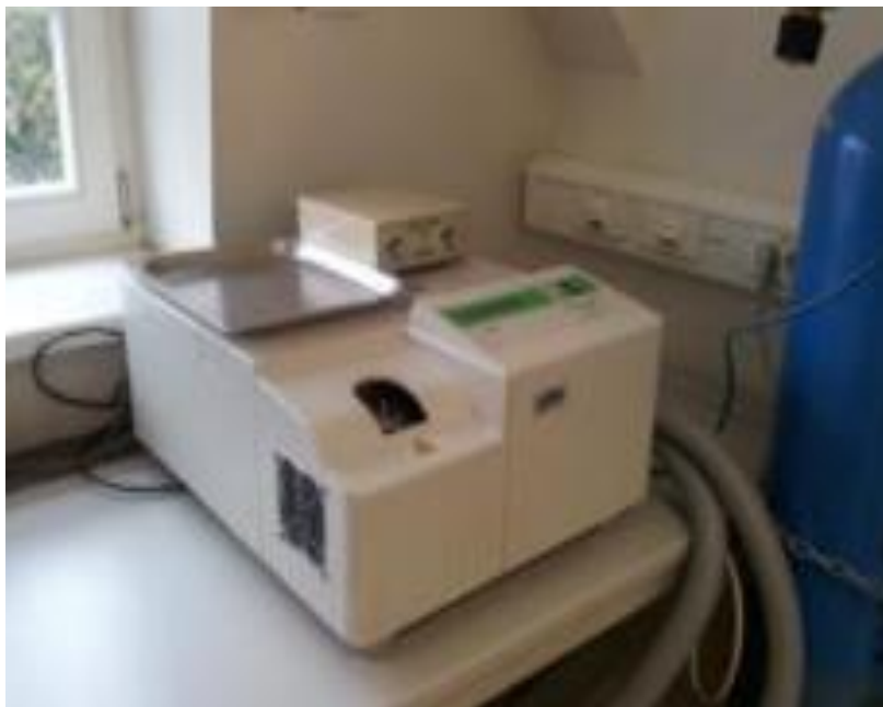
Slika 22. Diferencijalni pretražni kalorimetar Mettler Toledo DSC 822 e
