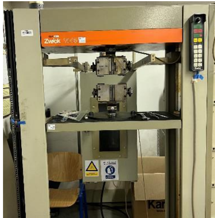
Slika 23. Univerzalna kidalica ZWICK 1445
