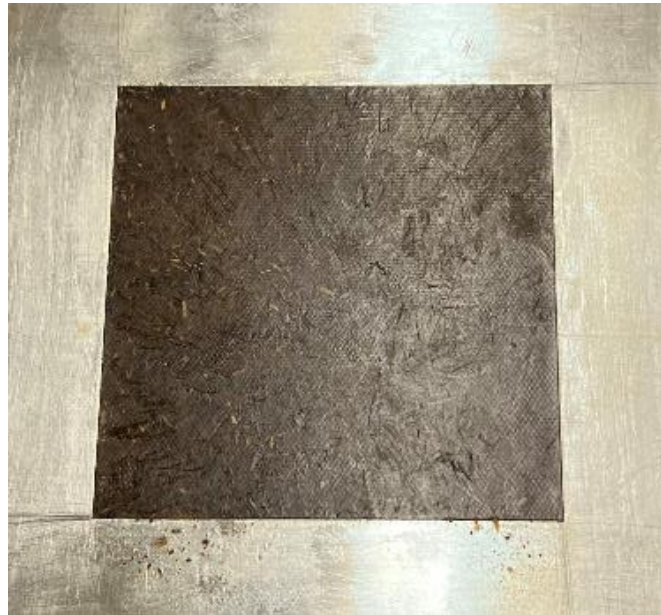
Slika 20. Pripremljeni uzorak PLA/maslina biokompozita
