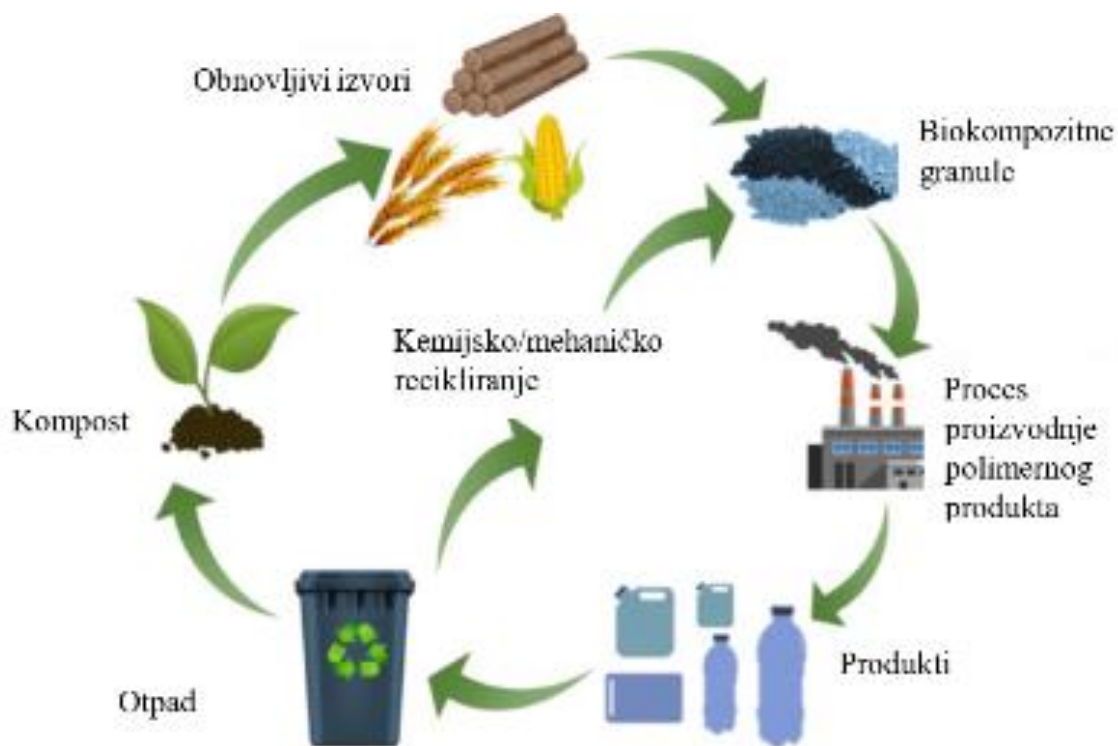
Slika 4. Kružni proces proizvodnje i obnavljanje biokompozitnog materijala [11]
