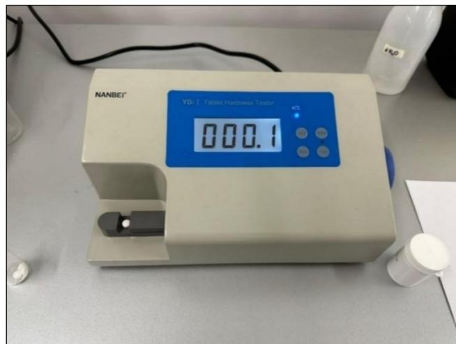
**Slika 19.** Fotografija uređaja za mjerjenje tvrdoće tablete YD-1 Tablet Hardness Tester,
