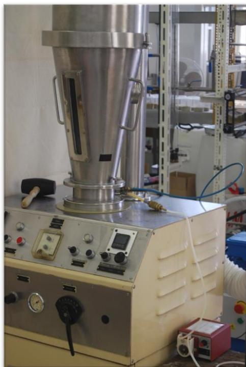
**Slika 15.** Fotografija granulatora s fluidiziranim slojem Uni-Glatt
