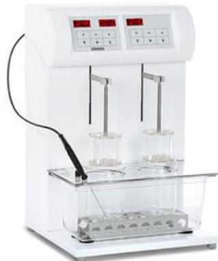
**Slika 20.** Fotografija uređaja za ispitivanje raspadljivosti tableta ZT 322
