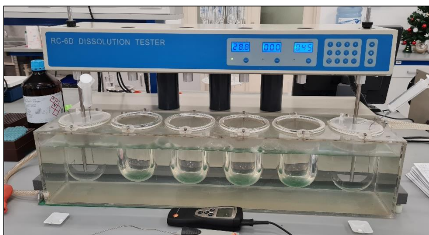
Slika 22. Fotografija uređaja za ispitivanje oslobađanja djelatne tvari RC-6D (Zhengzhou Nanbei Instrument, Henan, NR Kina)
