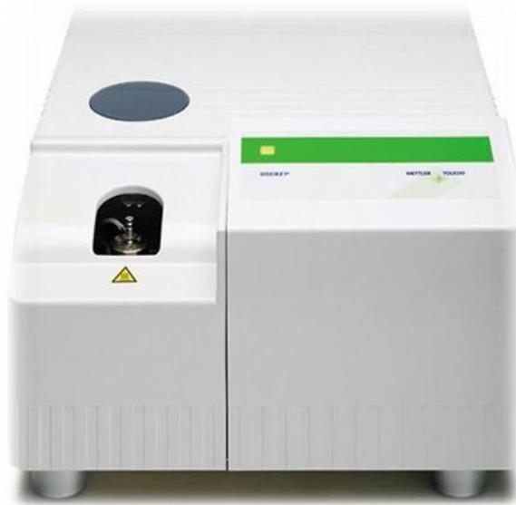
**Slika 12.** Fotografija diferencijalnog pretražnog kalorimetra Mettler Toledo 822e
