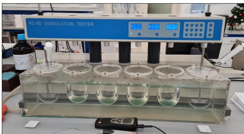
**Slika 22.** Fotografija uređaja za ispitivanje oslobađanja djelatne tvari RC-6D
