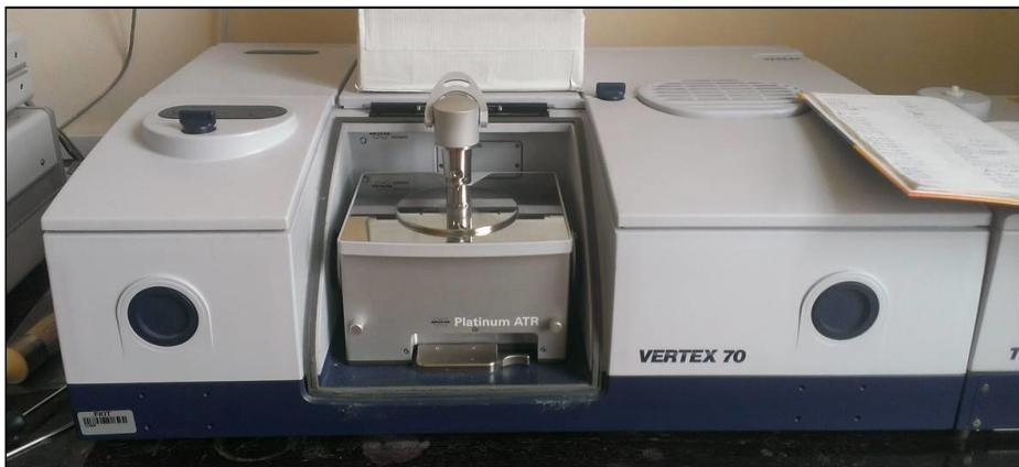
**Slika 14.** Fotografija FTIR spektrometra Vertex 70 s platinastim detektorom
