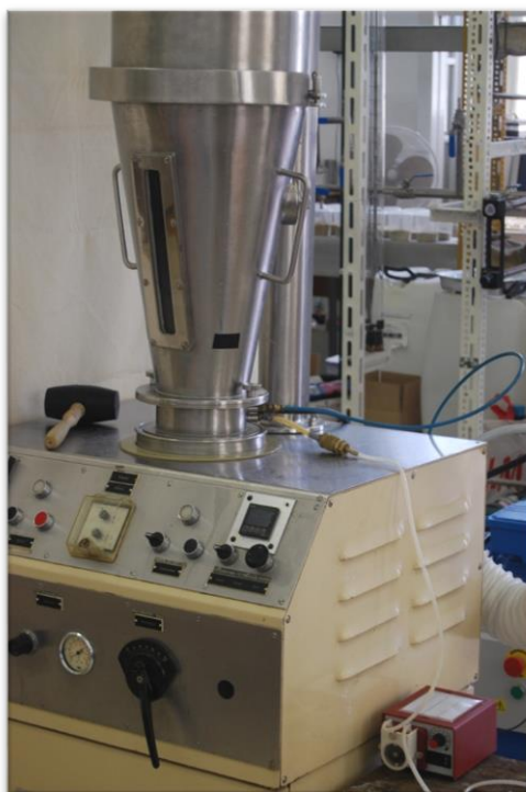
Slika 15. Fotografija granulatora s fluidiziranim slojem Uni-Glatt (Glatt GmbH, Binzen, SR Njemačka)
