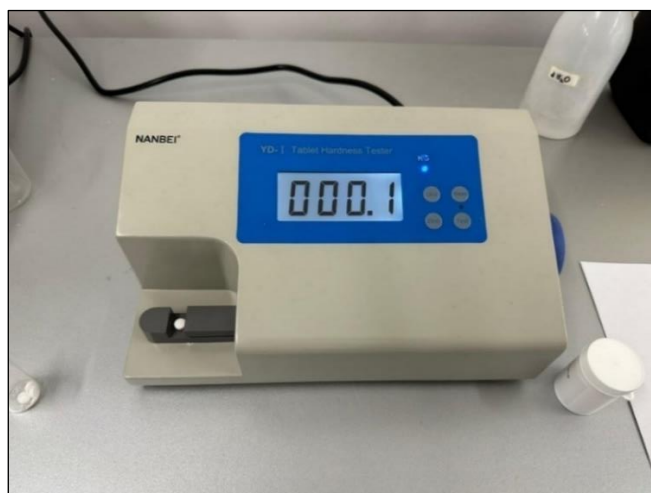
Slika 19. Fotografija uređaja za mjerenje tvrdoće tablete YD-1 Tablet Hardness Tester, (Zhengzhou Nanbei Instrument, Henan, NR Kina)
