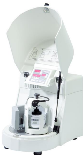
Slika 9. Fotografija planetarnog kugličnog mlina Pulverisette 6 (FRITSCH GmbH, Idar-Oberstein, SR Njemačka)
