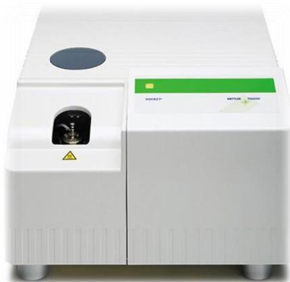
Slika 12. Fotografija diferencijalnog pretražnog kalorimetra Mettler Toledo 822e (Mettler Toledo GmbH, Greifensee, Švicarska)
