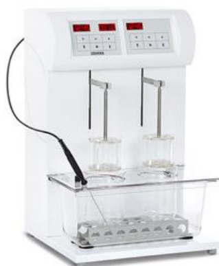
Slika 20. Fotografija uređaja za ispitivanje raspadljivosti tableta ZT 322 (Erweka GmbH, Langen, SR Njemačka)
