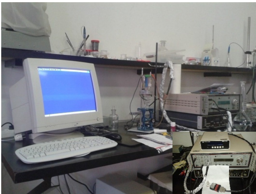
Slika 3.2. Aparatura za elektrokemijska ispitivanja.
