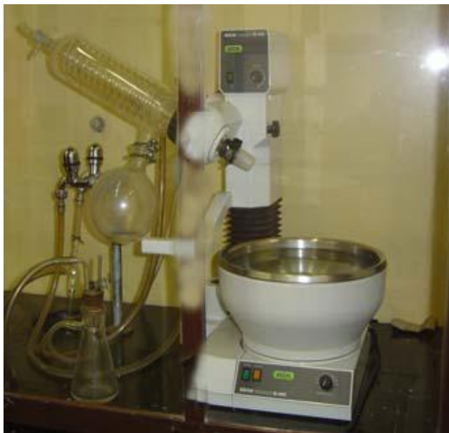
Slika 3.2. Rotirajući uparivač otapala R-114/A, Büchi, Švicarska
