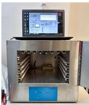
Slika 40. CCP-ICH2 fotokemijski reaktor proizvođača Luzchem.
