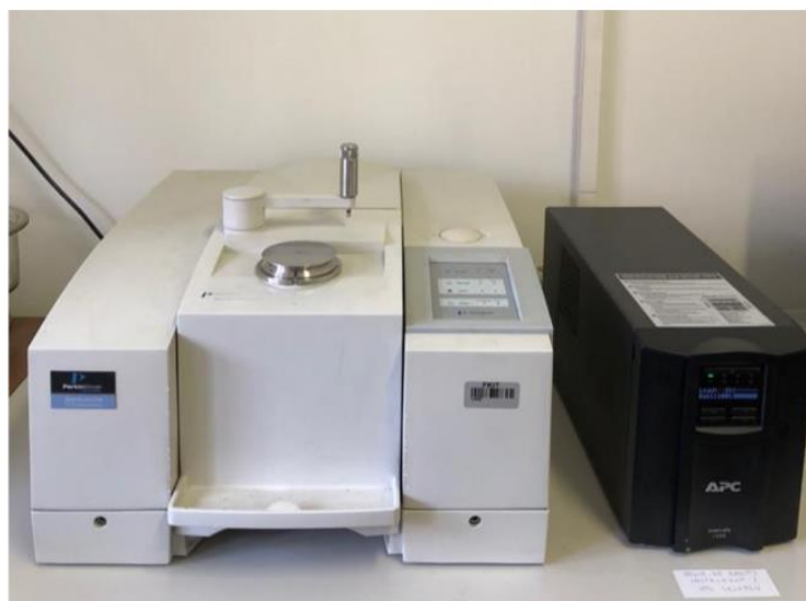
Slika 42. PerkinElmer Spectrum One infracrveni spektrofotometar s Fourierovom transformacijom signala.
