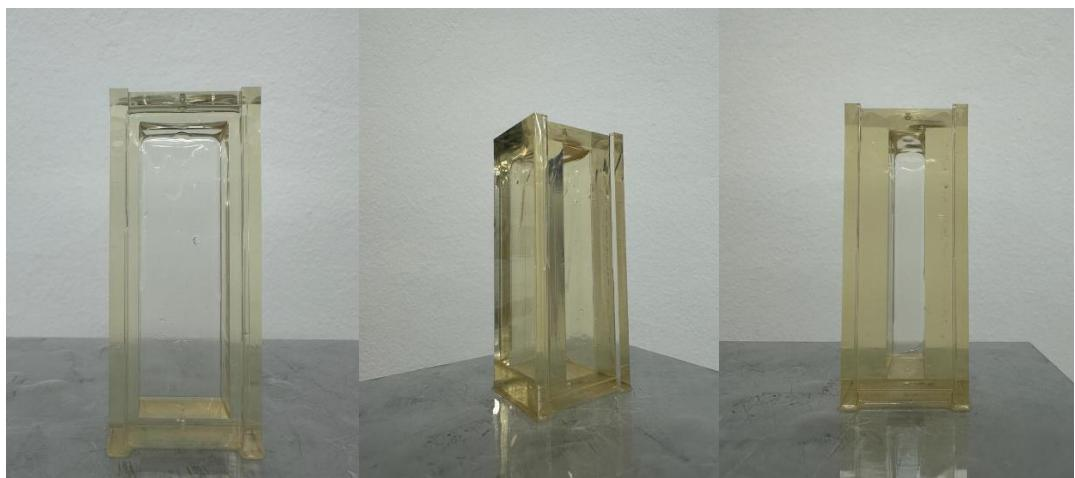
Slika 33. 3D-ispisani modeli reaktora.
