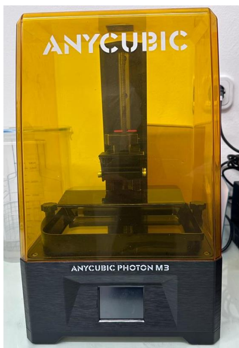
Slika 32. 3D-pisac̃ Photon M3 proizvođača Anycubic.
