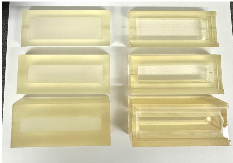
Slika 34. 3D-ispisani reaktori DLP tehnologijom od materijala PrimaCreator Value UV/DLP Clear Resin nakon ispiranja u izopropanolu.
