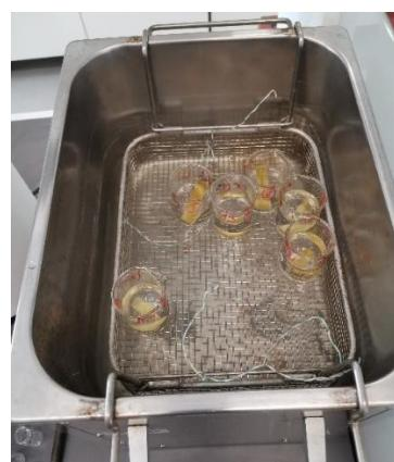
**Slika 38.** Ispitivanje adhezije uzorka ultrazvučnom kupelji.
