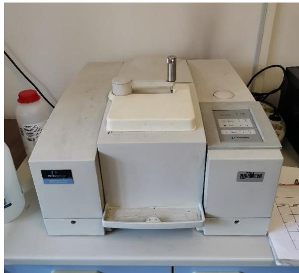
**Slika 34.** Spectrum One Perkin-Elmer spektrometar.
