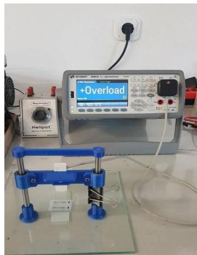
**Slika 37.** Uređaj za mjerjenje električne provodnosti (sonda s 4 točke).
