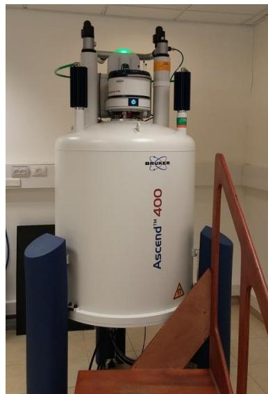
**Slika 33.** Bruker Avance III HD spektrometar.
