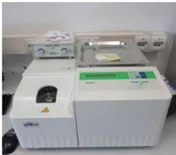
Slika 36. DSC uređaj Mettler Toledo 823eT.
