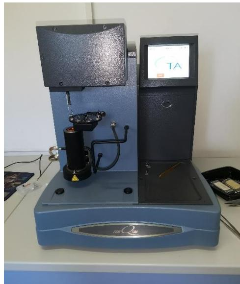
**Slika 35.** TA Instruments Q500 termogravimetar.
