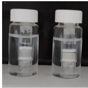
Slika 56. Supelco kolone punjene AL i SL smolama, okružene vodom i pripremljene za brojenje na tekućinskom scintilacijskom brojaču.
