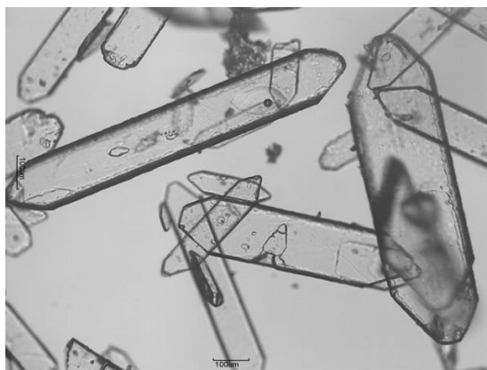
Slika 26. Fotografije kristala memantin hidrogen sulfata za sustav 2-propanol / etilacetat (75/25): a) brzo dodavanje EtOAc i b) dokapavanje EtOAc (uvećanje 100x)
