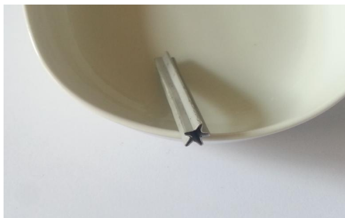
Slika 4.5 Zvjezdasta struktura metalnog monolita Al/Al 2 O 3
