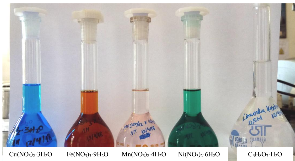
Slika 4.7 Otopine potrebne za pripremu katalitički aktivnog sloja na \text{Al}/\text{Al}_2\text{O}_3 metalnim monolitima
