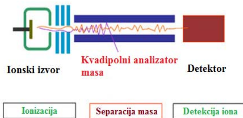
Slika 7. Shematski prikaz rada spektrometra masa
