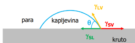
Slika 3.19. Youngov kontaktni kut na idealnoj površini.
