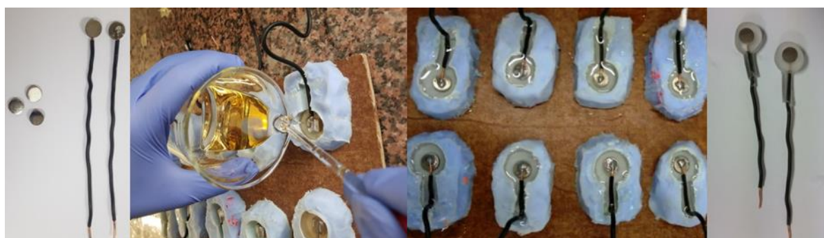
Slika 3.1. Postupak izrade radnih elektroda.
