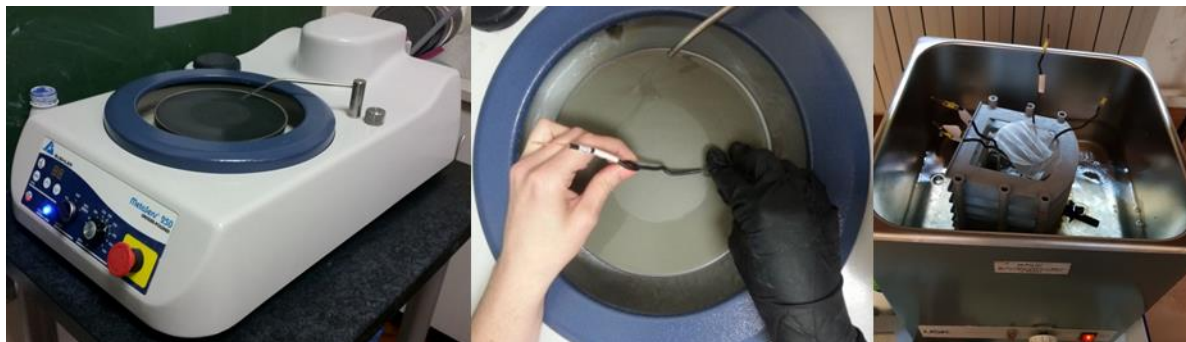
Slika 3.2. Mehaničko strojno poliranje te čišćenje uzoraka u ultrazvučnoj kupelji.
