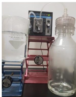
Slika 3.7. Aparatura korištena za membransku filtraciju prirodnih voda.
