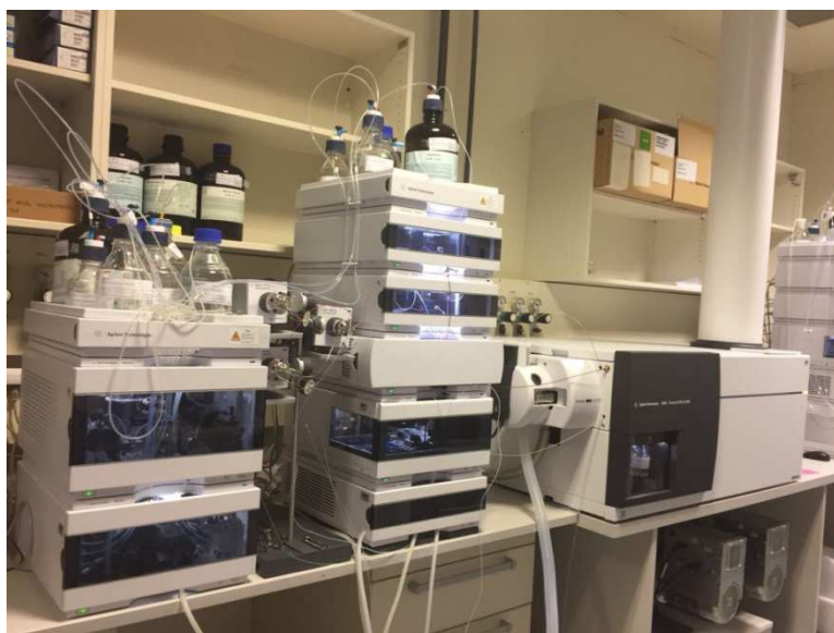
Slika 25. Tekućinski kromatograf ultravisoke djelotvornosti povezan sa spektrometrom masa visoke razlučivosti (2D-UHPLC-QTOF)
