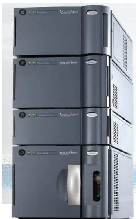
Slika 28. Kromatograf za fluidnu kromatografiju pri superkritičnim uvjetima (UPC 2 ) povezan s detektorom s nizom dioda (PDA)
