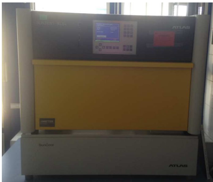
Slika 29. Uređaj za osvjetljivanje simuliranim Sunčevim zračenjem Suntest XLS+
