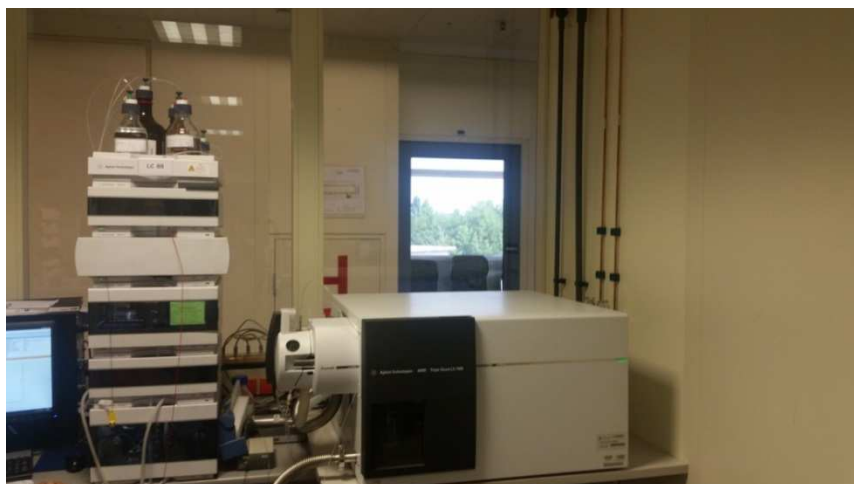
Slika 24. Tekućinski kromatograf ultravisoke djelotvornosti (Agilent 1290) vezan sa spektrometrom masa s trostrukim kvadripolom (Agilent 6490 )
