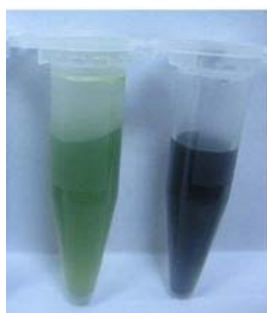
Slika 2.7. Promjena oksidacijskog stanja polianilina očituje se elektrokromizmom.
