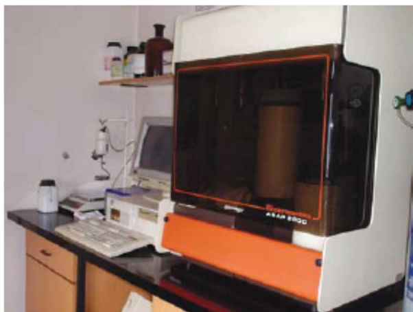
Slika 30. Uređaj za plinsku adsorpcijsko-desorpcijsku analizu
