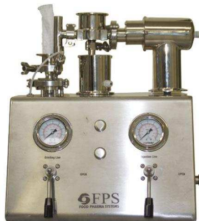
Slika 26. Laboratorijski spiralno strujni mlin LaboMill, FPS
