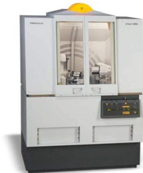
Slika 31. Rendgenski difraktometar Philips PANalytical X'Pert Pro MPD
