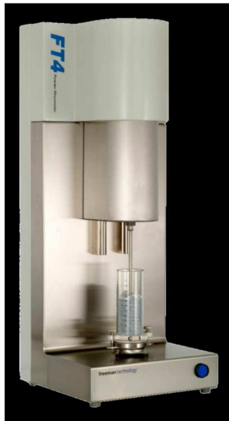
Slika 35. Analizator tecivosti praha FT4
