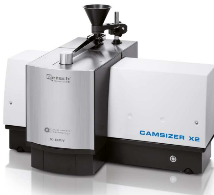
Slika 29. Uređaj za mjerenje veličine čestica Camsizer X2
