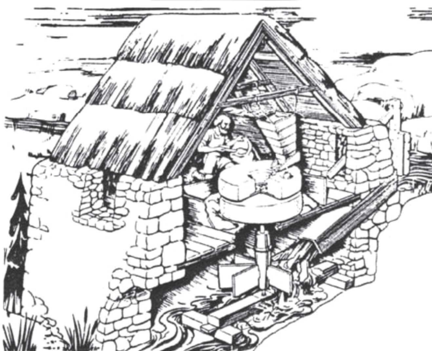
Slika 3. Grčki tip vodenog mlina 7
