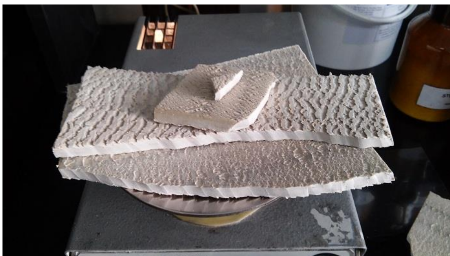
Slika 3.1. Prvi stupanj gumene mješavine
