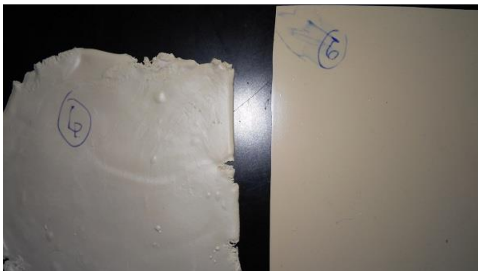
Slika 3.11. Neumreženi (lijevo) i umreženi (desno) uzorak
