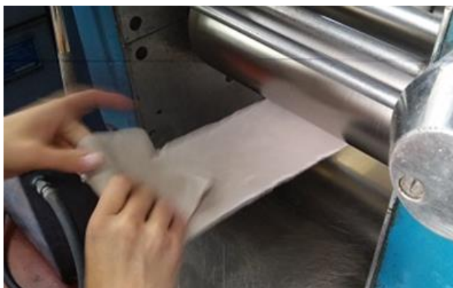
Slika 3.9. Umješavanje na dvovaljku
