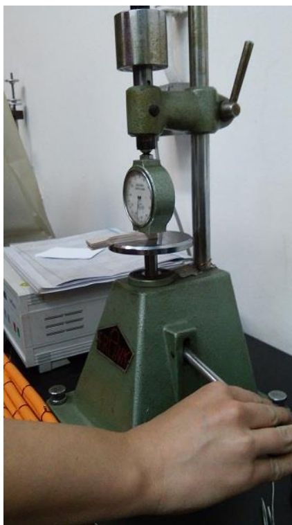
Slika 3.6. Mjerenje tvrdoće na tvrdomjeru
