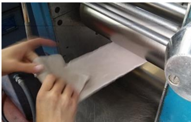
Slika 3.9. Umješavanje na dvovaljku
