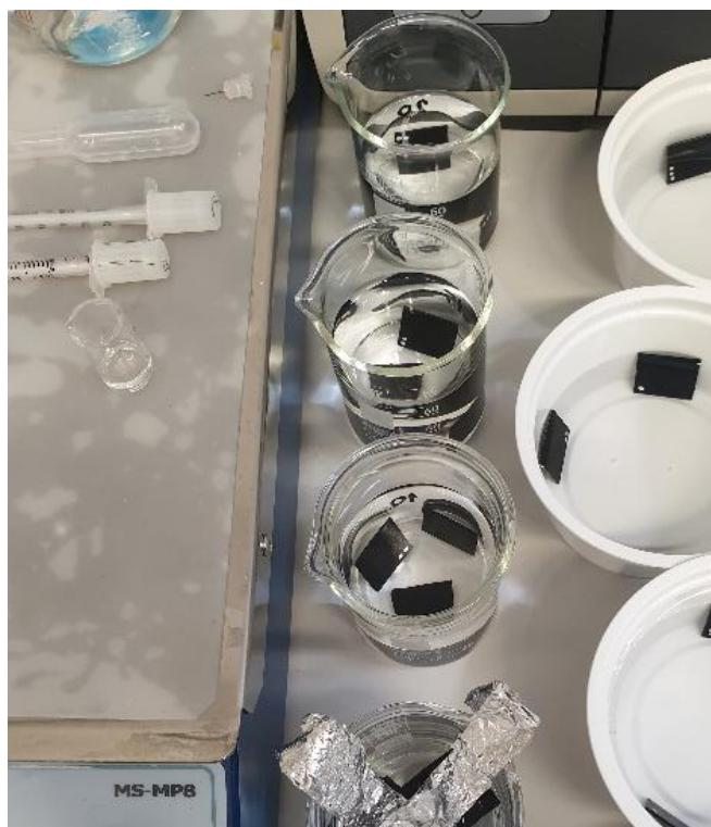
Slika 24. Uzroci pripremljeni za određivanje stupnja bubrenja
