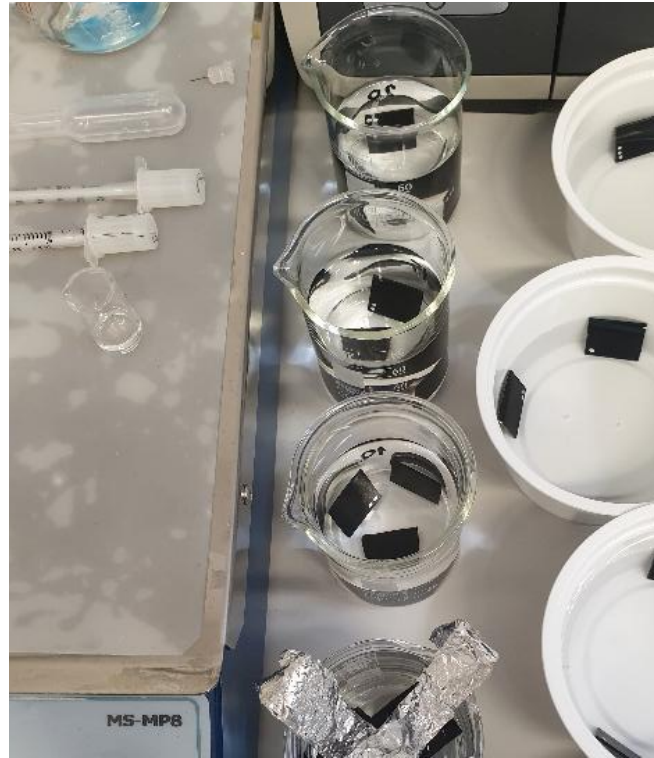
Slika 24. Uzroci pripremljeni za određivanje stupnja bubrenja
