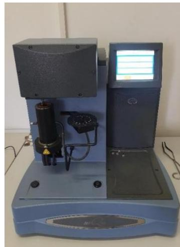
Slika 23. Termogravimetrijski analizator Q500, TA Instruments
