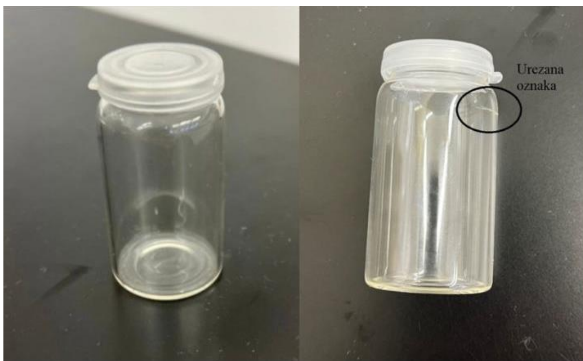
Slika 10. Prikaz korištenog improviziranog piknometra s urezanim oznakom
