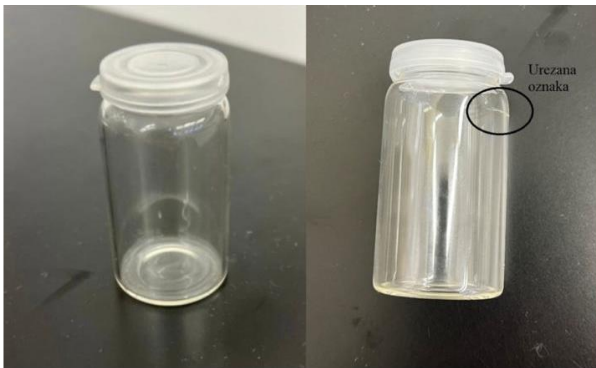
Slika 10. Prikaz korištenog improviziranog piknometra s urezanim oznakom
