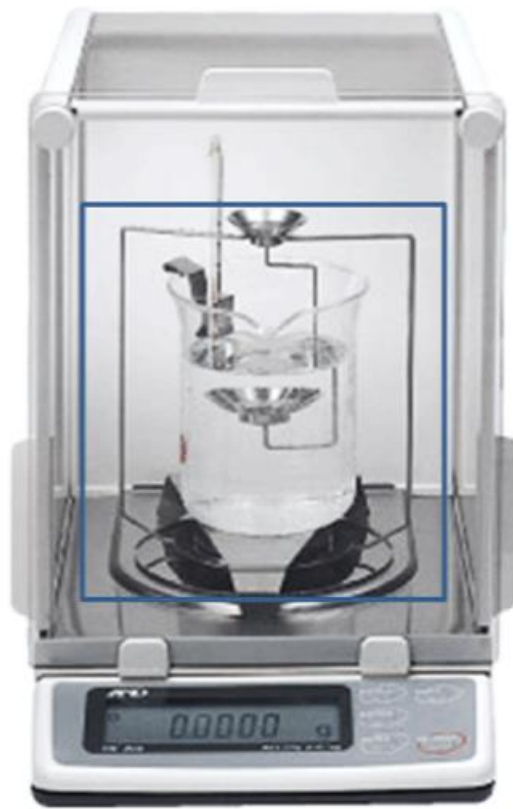
Slika 5. Prikaz postava za određivanje gustoće Arhimedovom metodom [16]
