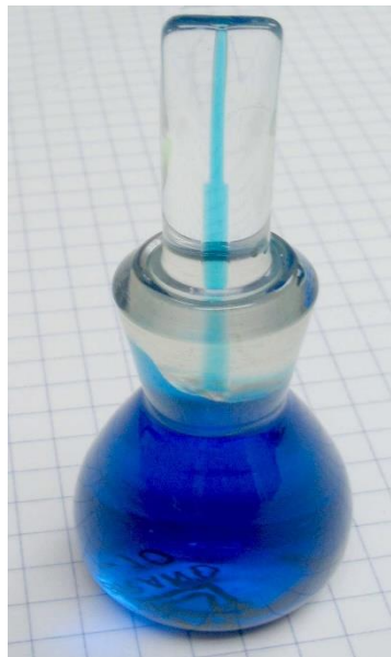
Slika 7. Prikaz piknometra napunjenog kapljevinom čija se gustoća određuje [19]
