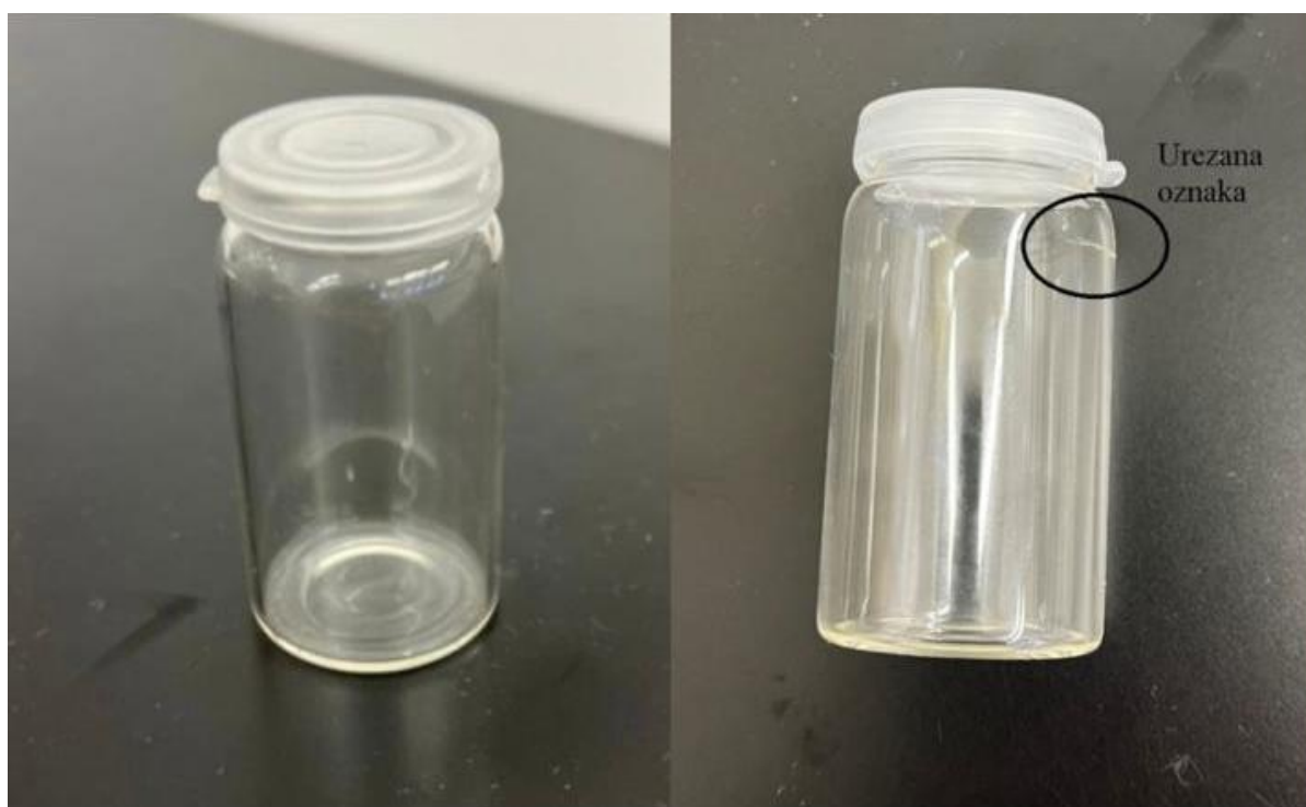
Slika 10. Prikaz korištenog improviziranog piknometra s urezanim oznakom
