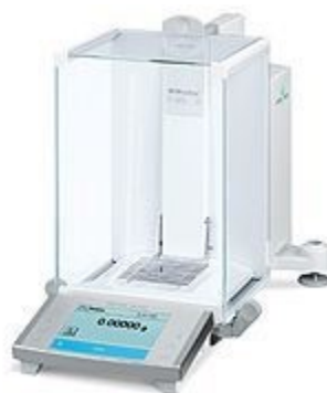
Slika 3.3. Analitička vaga Mettler Toledo XA105DU [43]
