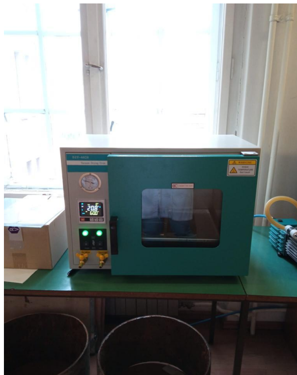
Slika 3.3 Vakumski sušionik EV-50, Raypa Španjolska
