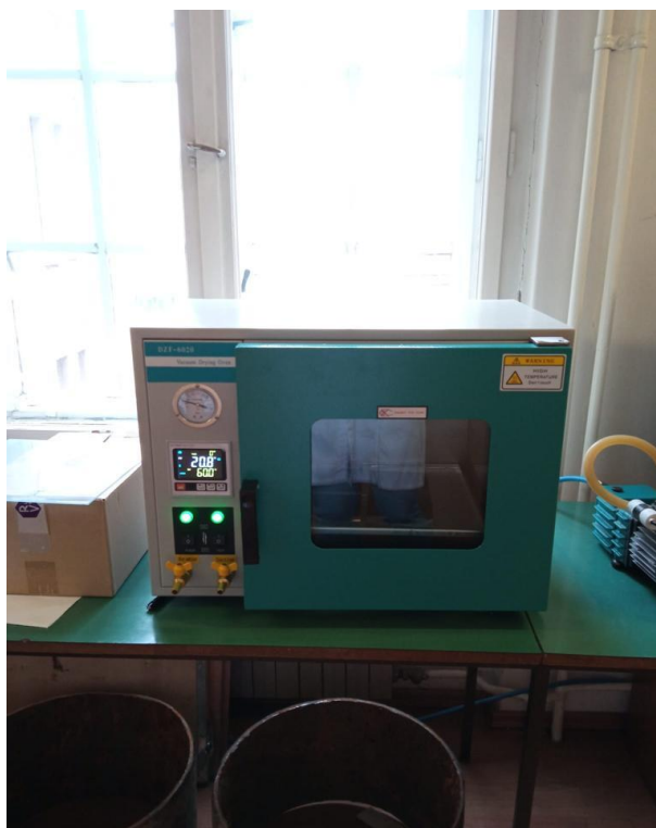
Slika 3.3 Vakumski sušionik EV-50, Raypa Španjolska
