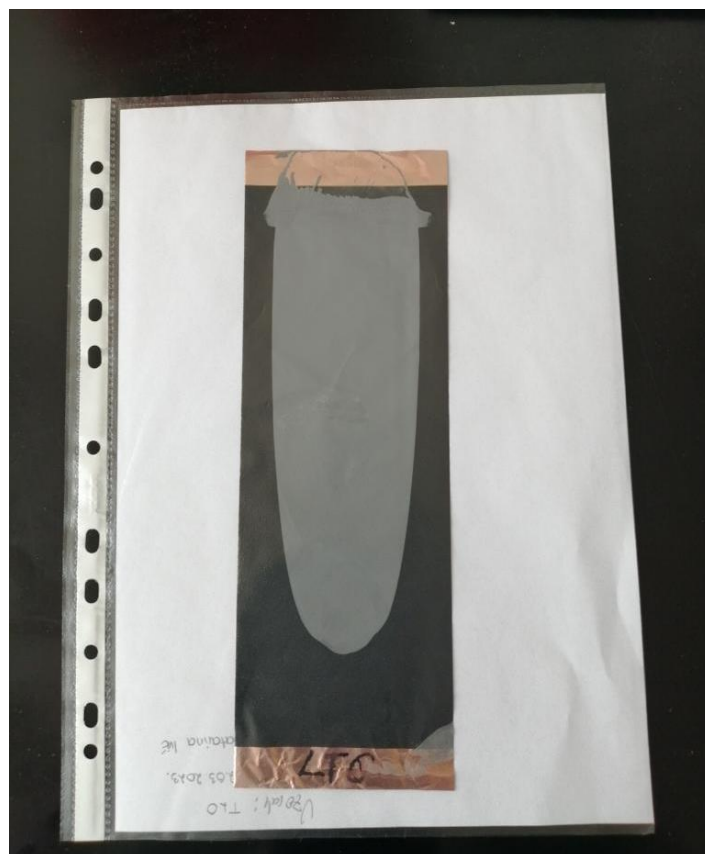
Slika 3.4 Dobiveni LTO anodni materijal
