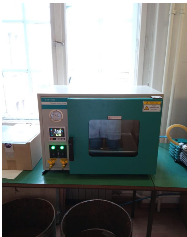
Slika 3.3 Vakumski sušionik EV-50, Raypa Španjolska
