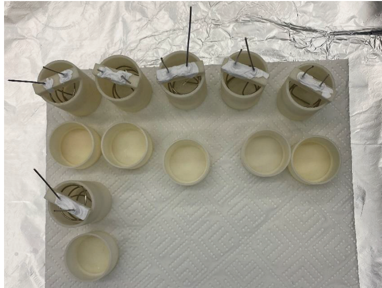
Slika 13. Elektrokemijska ćelija za PVA i agar hidrogelove
