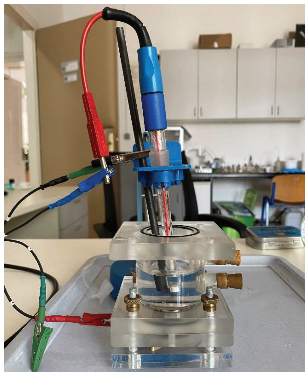
Slika 11. Elektrokemijska ćelija s tekućim elektrolitom
