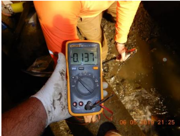
Slika 10. Mjerenje elektrokemijskog potencijala[28]
