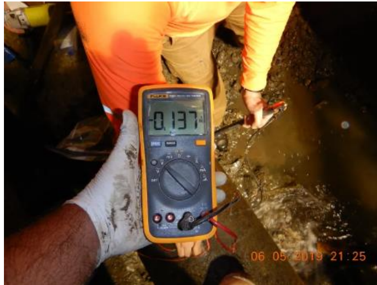
Slika 10. Mjerenje elektrokemijskog potencijala[28]
