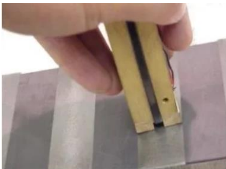
Slika 12. Provedba mjerenja grafitizacije[28]
