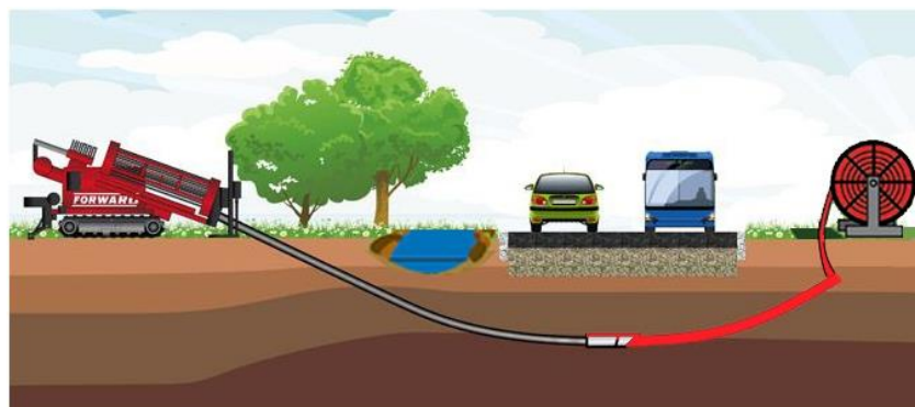
Slika 16. Prikaz zamjene vodovodnih cijevi metodom 2.[31]
