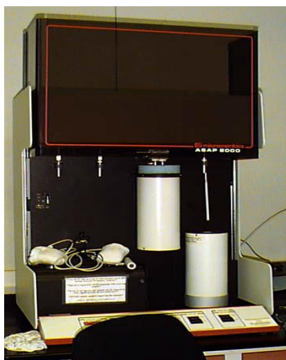
Slika 3.1. Uređaj za određivanje veličina pora, ASAP 2000 ( Micromeritics, SAD )
