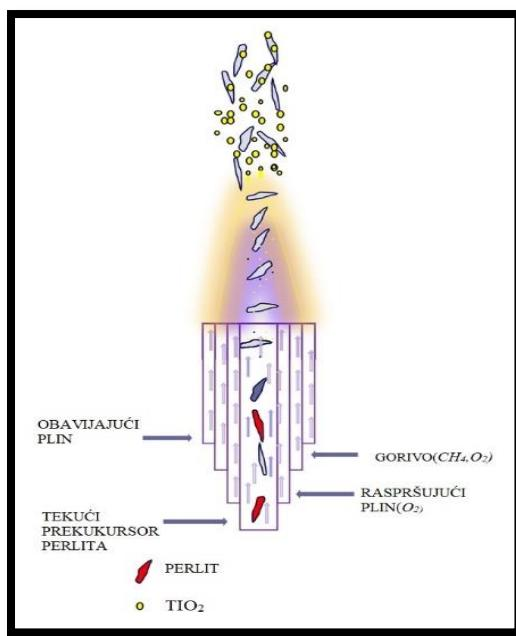
*Slika 3.3.* Shematski prikaz uređaja za pirolizu raspršivanja plamena.<sup>[28]</sup>
