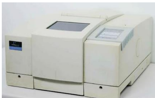
Slika 3.3.1.: FTIR spektrofotometar PerkinElmer Spectrum One
