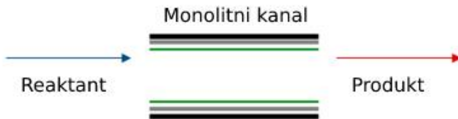
Slika 18. Prikaz prolaska reaktanta kroz monolitni kanal. Monolitna stijenka= crna boja, sekundarni nosač= siva i sloj katalizatora= zelena [25].
