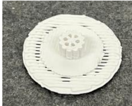
Slika 23. Monolitni nosač katalizatora ZDP geometrije dobiven upotrebom optimalnih postavki i povećanjem brzine hlađenja materijala
