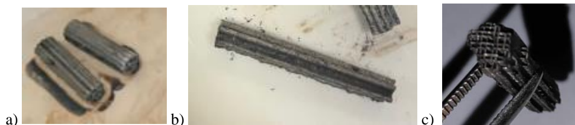
Slika 34. Nosači katalizatora s nanesenim \text{MnFeO}_x katalitičkim slojem: a) ZDP geometrije b) Z geometrije c) M geometrije
