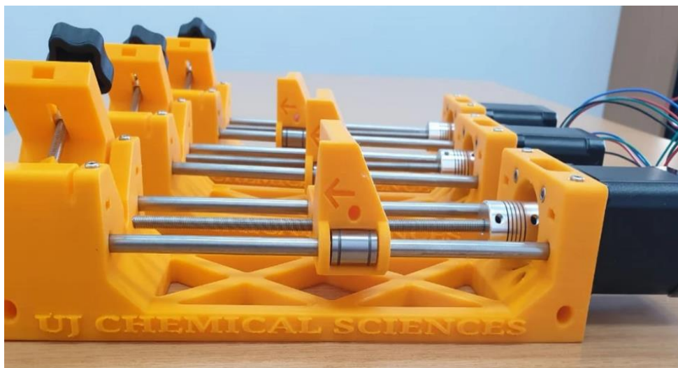
Slika 7. Laboratorijska pumpa za šprice izrađena uz upotrebu aditivne proizvodnje [40]
