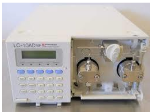
Slika 5. Visokotlačna pumpa, Shimadzu Liquid Chromatography
