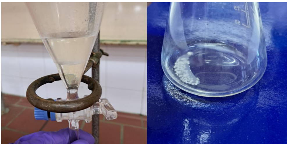
Slika 14. Ispiranje destilata vodenom otopinom natrijevog karbonata (lijevo) i sušenje organske faze bezvodnim kalcijevim kloridom (desno)
