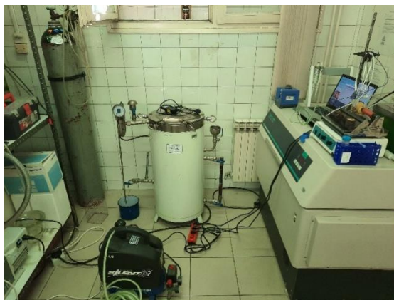
Slika 11. Aparatura za određivanje vrijednosti volumnog koeficijenta otapanja kisika
