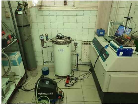
Slika 11. Aparatura za određivanje vrijednosti volumnog koeficijenta otapanja kisika
